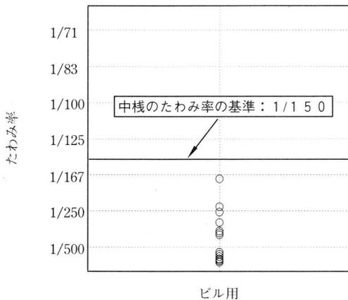
図13 耐風圧性能比較 (中棧のたわみ率)
