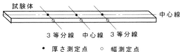
図2 試験体寸法測定位置
