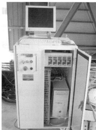
写真4 200kN自動載荷試験装置（制御操作盤）
