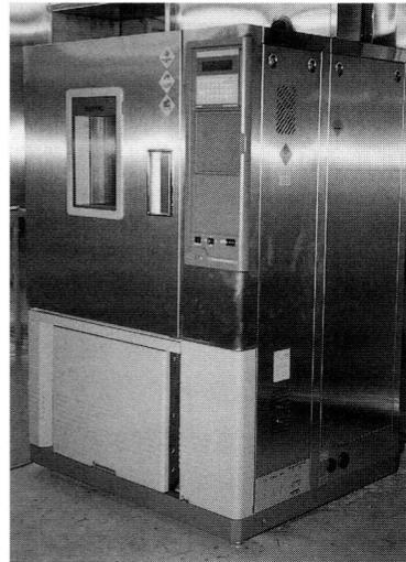
写真3 インキュベーター（恒温恒湿槽）
