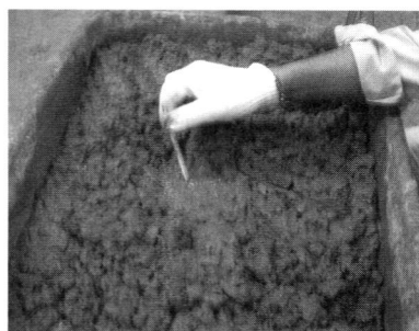
写真2 アルコール温度計を用いて温度測定を行っている状況
