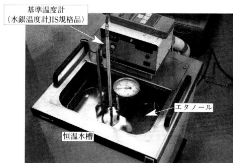
写真6 温度計の校正
