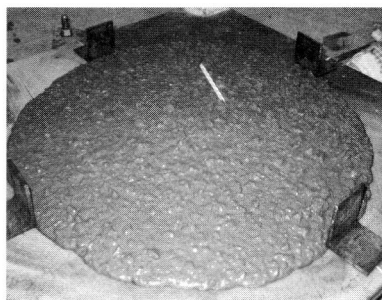
写真3 スランプフロー試験後の試料で温度測定を行っている状況
