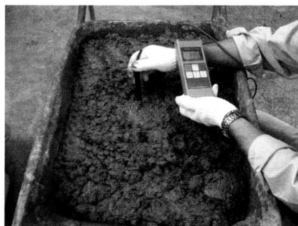
写真5 デジタル温度計を用いて温度測定を行っている状況
