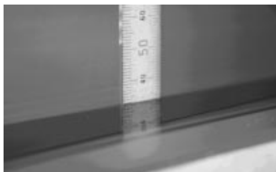
写真3 試験体2, 試験条件III, 圧力差250Pa
