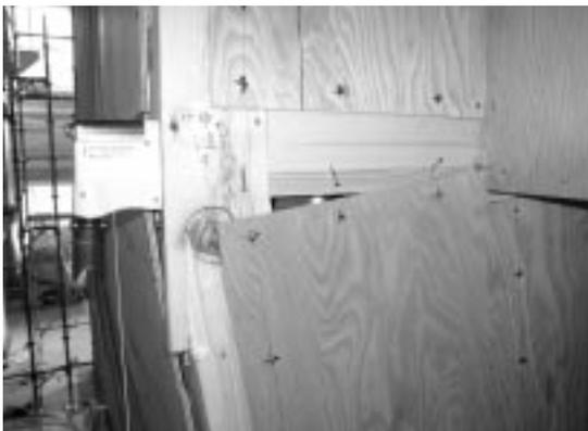
写真5 柱頭の曲げ破壊
