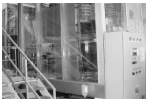
写真11 揮発性有機化合物計測のチャンバー
