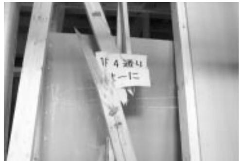
写真6 筋かいの座屈破壊
