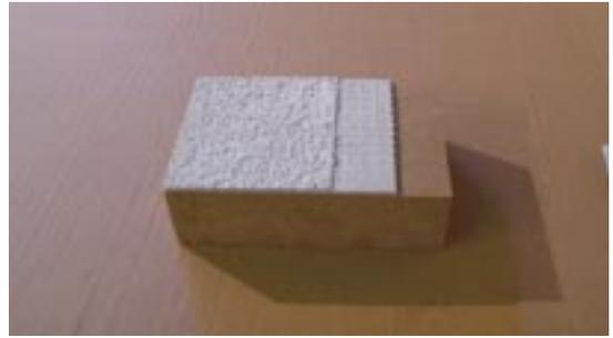
写真11 木繊維ボード、表面は接着モルタルで仕上げる
