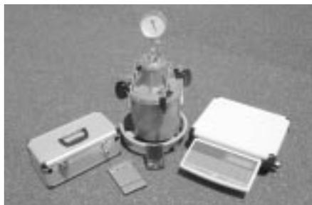
写真1 土木研究所法 単位水量迅速推定システム CF13
