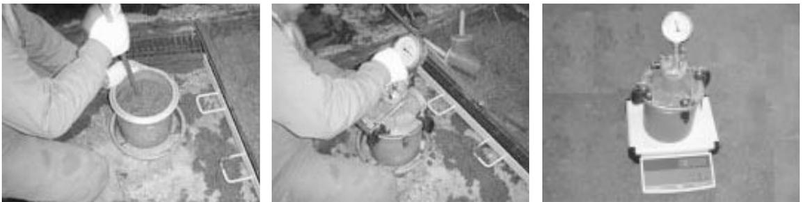
写真4 空気量及び質量の測定
