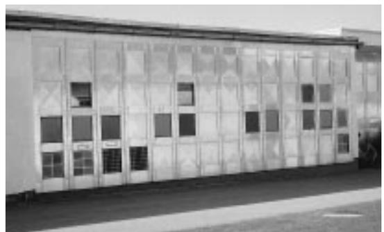
写真10 各種表面仕上材料の耐候性試験
