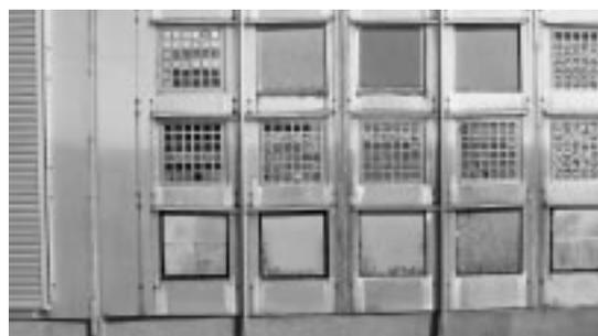
写真2 外壁材料の水分移動の実験、含水率分布はNMRで測定する
