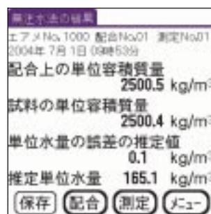
図7 単位水量測定結果
