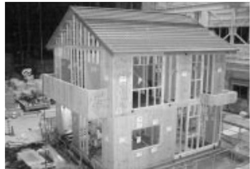
写真7 金物工法試験体
