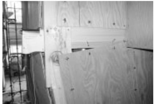
写真5 柱の曲げ破壊
