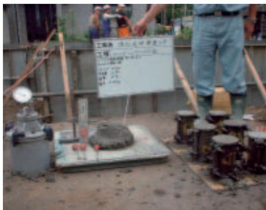
写真2 基礎コンクリートの品質試験
