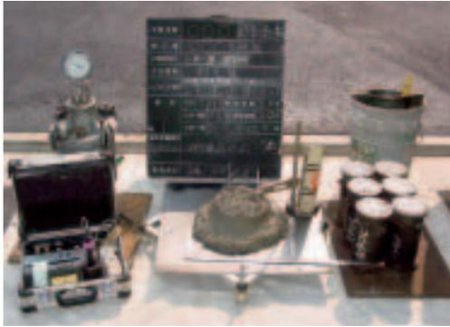
写真1 打設現場でのフレッシュコンクリートの品質管理試験状況
