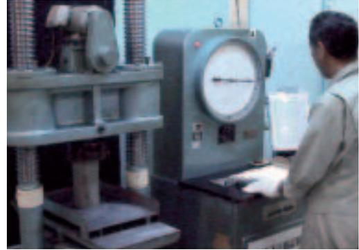
写真2 コンクリートの圧縮強度試験状況
