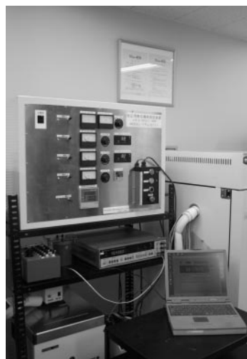
写真3 制御部及び計測部
