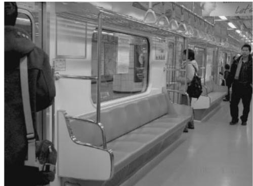
写真7 ソウル地下鉄 不燃化されたステンレス製の椅子
