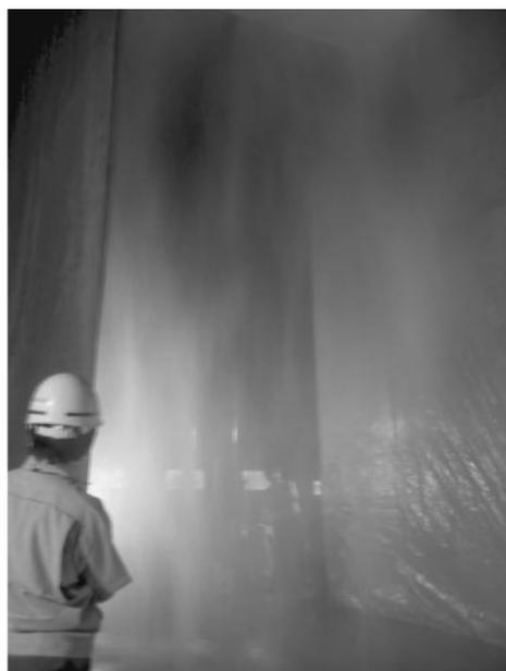
写真6 高さ6m時のウォータースクリーンの状況
