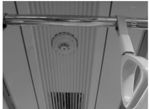
写真10 ソウル地下鉄列車天井に設置された感知器
