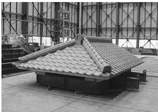
写真2 実験に供されたJ形屋根
