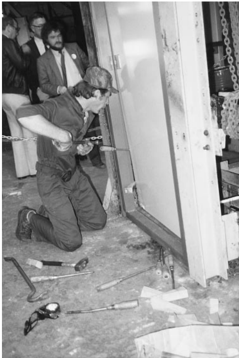
フランスの建材試験所で行われた人力による開扉試験。15分を限度に行いましたが体力もあり、杵も含めてくさびを上手に使いながら、下から錠の下端に取り付き錠を破壊し開扉しました。
