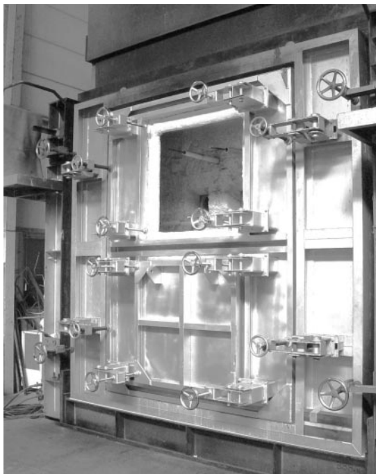
写真2 壁加熱炉設置後
