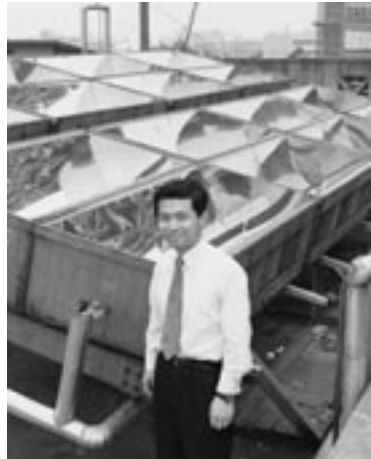
写真1 早稲田大学58号館屋上の太陽熱冷房実験装置の前で。手作りのパラボリックシリンドー集熱器を鉄骨の架台に載せ、全体をチェーンブロックで上下させて太陽の軌道にあわせる。(1973年)
