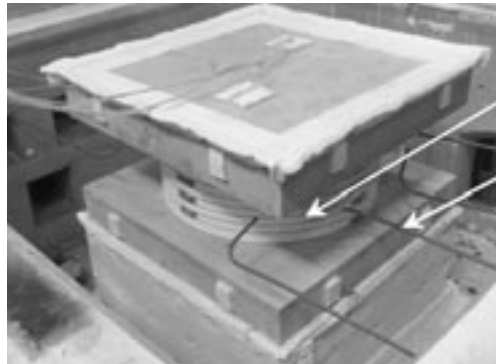
写真5 積層ゴム系免震装置（高減衰ゴム）の加熱試験による試験体の設置状況。なお、免震装置の被覆は、円形被覆の方法を取っている。
