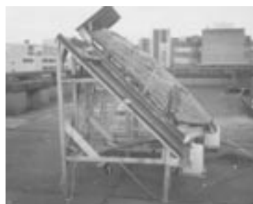
写真1 茅葺屋根とトタン屋根の実大実験模型
