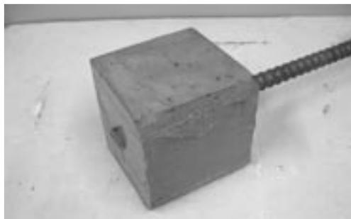
写真3 鉄筋とコンクリートとの付着強度試験用供試体
