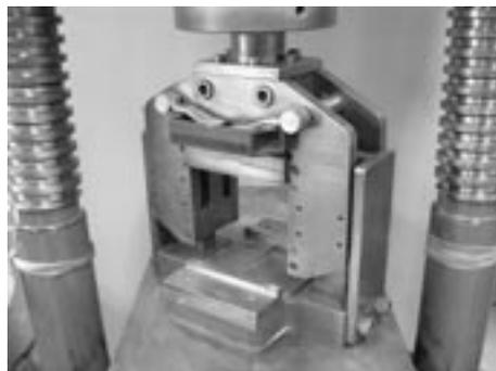
写真4 せん断試験用ジグの一例
