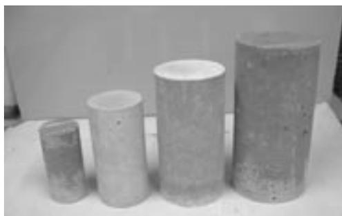
写真1 圧縮強度及び割裂引張強度試験用供試体
