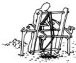
井戸を掘る人と 木製の巻き上げ機
