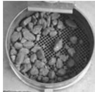
写真2 ウェットスクリーニングの状況(写真上はスクリーニング前、写真下はスクリーニング終了の状態)
