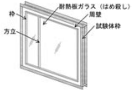
図3 耐熱板ガラスの遮炎性能試験体
