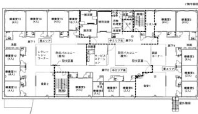
図2 老健施設「風の杜」（早大・入江正之研究室設計） 2階平面（文献4より）。各階の内側に2箇所の「防災バルコニー」が設けられ、外周バルコニーは設けられていない。療養室階は4つの水平区画に分割し（図の破線）、どこで出火してもその直接の影響が及ぶ範囲が局限化される。
