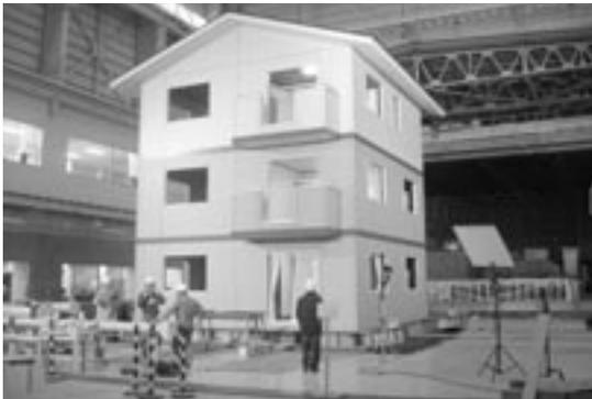
(社)日本ツーバイフォー建築協会は、4月24日に(独)土木研究所において実施したツーバイフォー工法による木造3階建て住宅の三次元振動台実験を公開しました。
