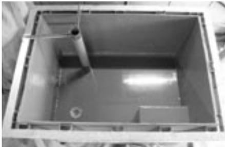
写真3 試験体作製状況 トップコート塗布後
