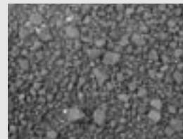
写真6 電気炉酸化スラグ細骨材
