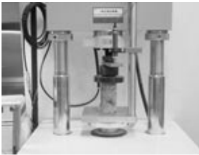
地盤改良材の一軸圧縮試験
