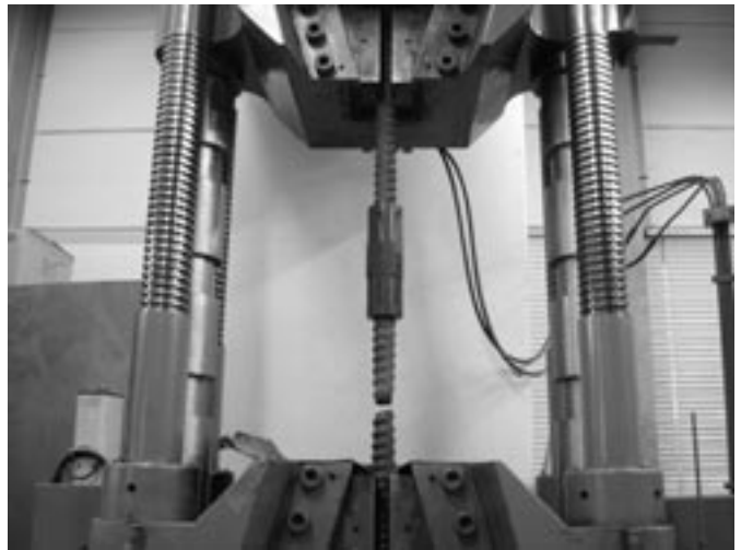
機械式継手の引張試験
