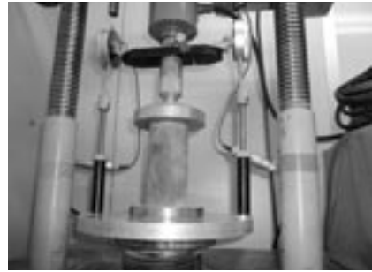
改良土の一軸圧縮試験
