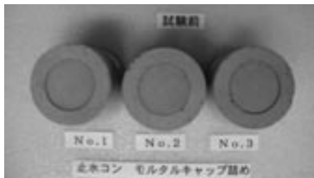
写真3 試験体 止水コンモルタルキャップ詰め
