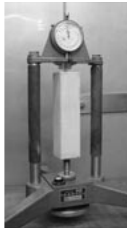
写真3 モルタル及びコンクリートの長さ変化試験状況 (ダイヤルゲージ方法)
