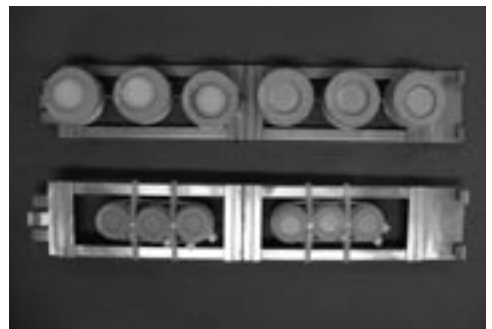
写真5 試験体のホルダーへの取付状況
