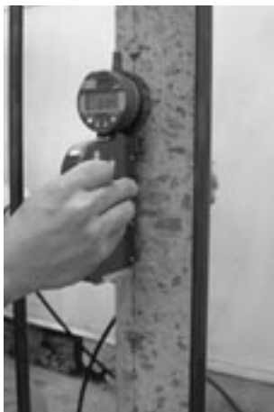
写真4 コンクリート(コア)の長さ変化試験状況 (コンタクトゲージ方法)
