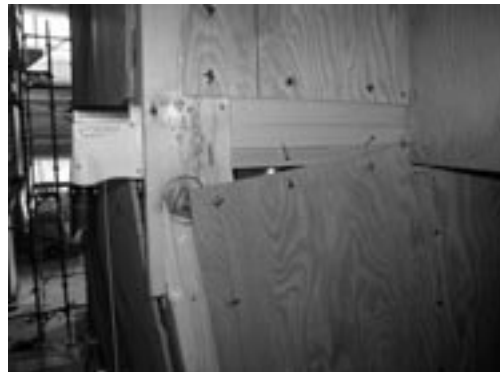
写真6 柱の曲げ破壊 (標準試験体 Ver.1)
