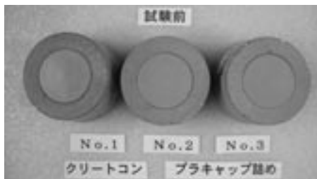
写真4 試験体 クリートコンプラキャップ詰め
