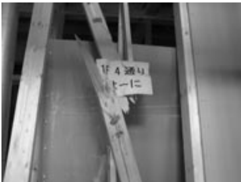
写真7 筋かいの座屈 (標準試験体 Ver.1)
