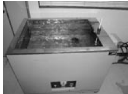
写真2 養生用恒温水槽
