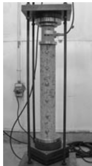
写真1 圧縮クリープ試験状況
