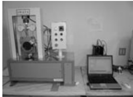
写真1 自動マーシャル安定度試験装置
