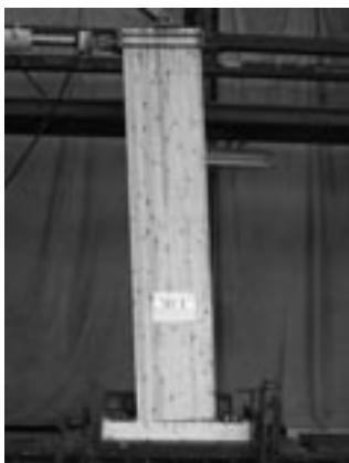
写真1 破壊状況 (全景) 試験体記号：SH-1 最大荷重：11.4kN
