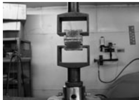
写真4 剥離試験状況
