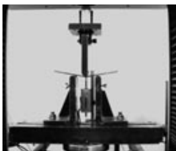
写真5 曲げ試験状況
