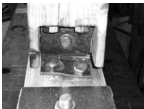
写真3 破壊状況 (M14-W金物の切れ) 試験体記号：SH-1 最大荷重：11.4kN
