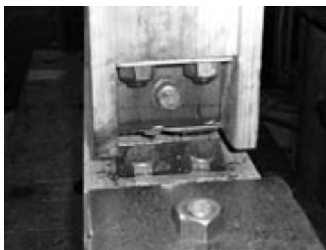
写真4 破壊状況 (M14-W金物の破断) 試験体記号：SH-2 最大荷重：11.1kN
