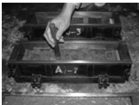
写真6 繰返し使用耐久性試験 (モルタルの打ち込み状況)
