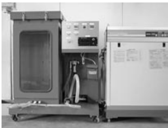
写真1 エア・エロージョン試験装置の外観 〔密閉装置（左側）内で、封じ込め処理したロックウール試験体に一定の条件で風圧を加え、繊維の飛散しないことを確認する。〕
