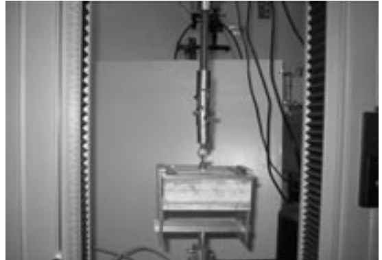
写真7 付着強度試験状況
