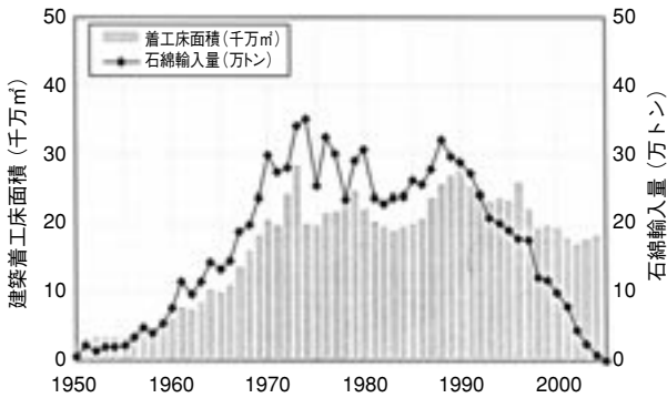
図4 アスベスト輸入量と建築物の着工床面積の関係 (1950年以降)
