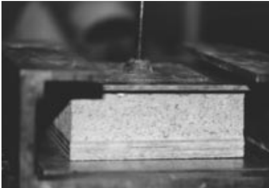
写真3 凝集／付着強さ試験の様子 (封じ込め処理したロックウール試験体に金具を取付け、周囲に切込みを入れ、引張り強さを測定し、封じ込め処理を行わないロックウール試験体と比較する。)
