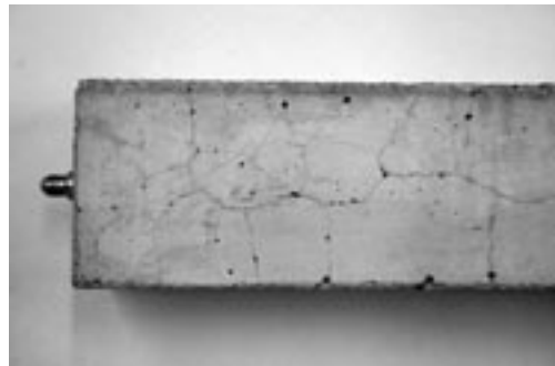
写真1 モルタルバーの表面に発生したひび割れの状況
