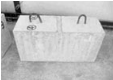
写真9 コンクリートの表面状態(廃木ボード50)
