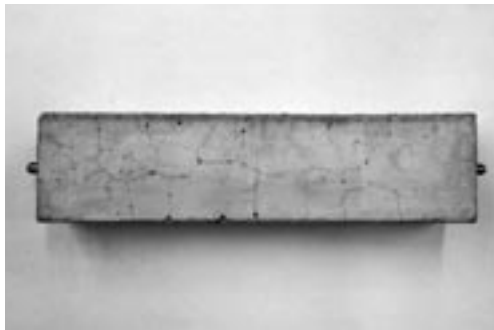
写真1 モルタルバーの表面に発生したひび割れの状況
