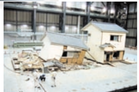
▶震動台実験による既存木造住宅の倒壊実験（三木市のEーディフェンス、(独)防災科学技術研究所）
