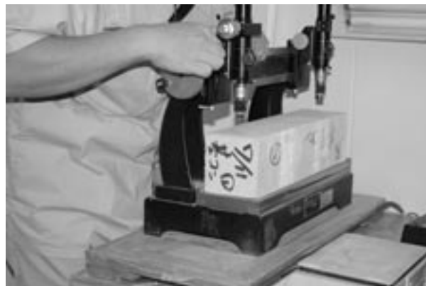
写真1 コンパレータによる長さ変化測定状況
