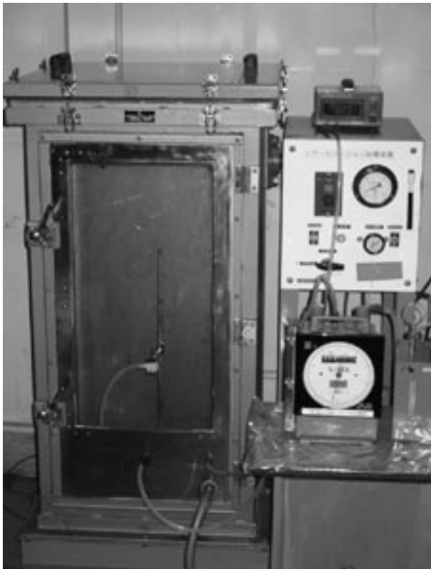
写真1 建材試験センターのエアエロージョン試験装置
