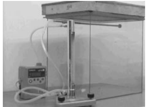
写真2 研究開発中の現場対応型エアエロージョン試験装置
