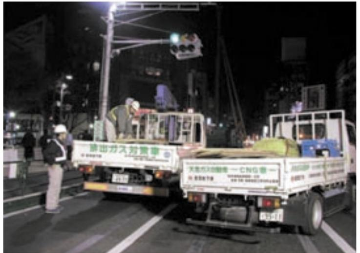
写真3 圧縮天然ガス車（CNG車）
