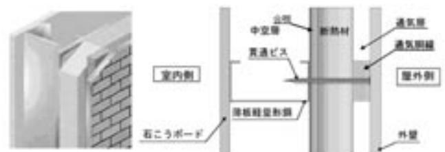
図2 スチールハウス工法の外壁構造
