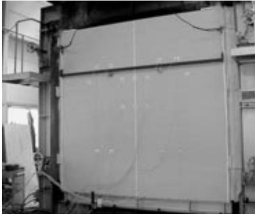
写真2 外壁耐火性能試験の様子
