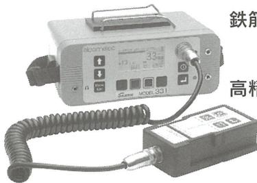
鉄筋の位置とかぶり厚さ、腐食度合をチェック出来る高精度の鉄筋探査機
