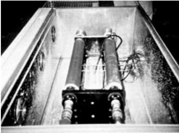
写真2 マスコンクリートひび割れ抵抗試験装置 4)
