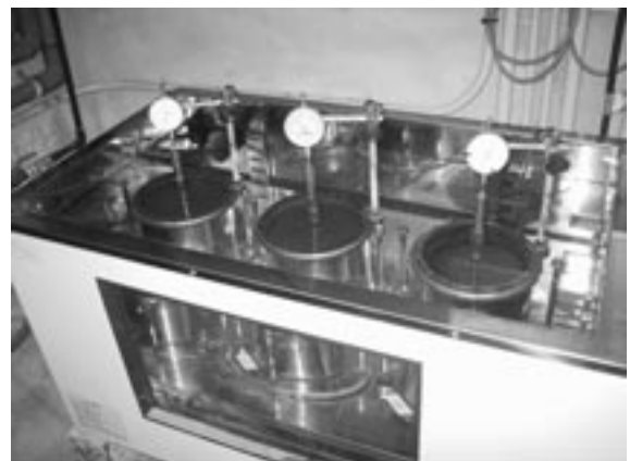
鉄鋼スラグ水浸膨張試験
