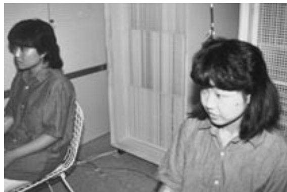
図2 気流感の被験者実験，背後は整流格子のある吹き出し気流装置，気流速の変動を正弦波など数種作った。
