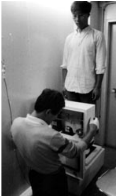
図4 発汗量を測る精密秤、最小目盛5g、感度1g
