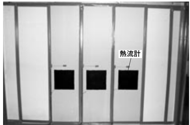
写真3 試験状況 (室内側)
