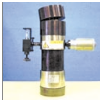
容積型力計（容量 2000 kN）
