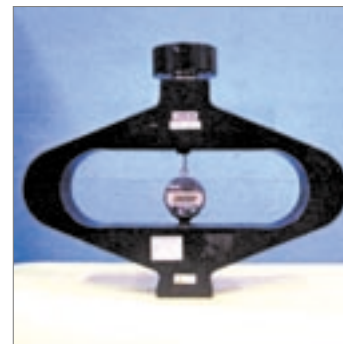
環状ばね型力計（容量 1000 kN）
