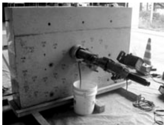
写真2 壁の模擬部材からのコア採取状況
