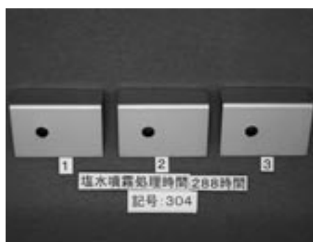
写真35 試験時間288時間の試験片の外観 記号：304
