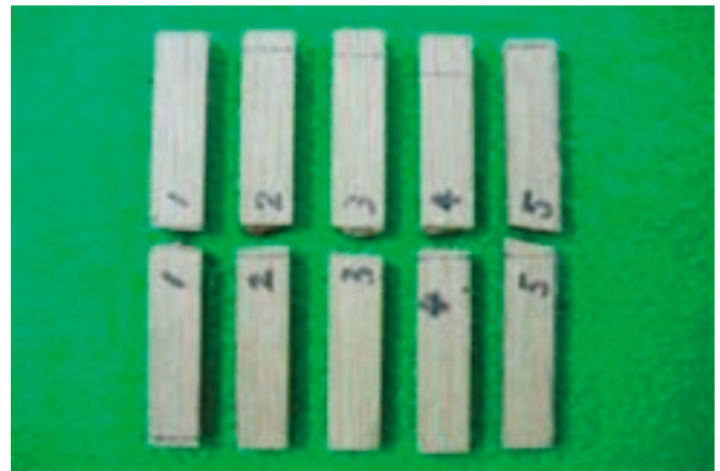
写真4 衝撃試験後の破壊状況 (温度-20 )
