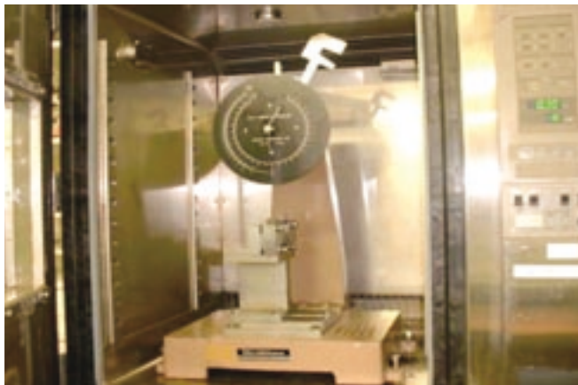
写真3 シャルピー衝撃試験機 (恒温チャンバー内で試験を実施)
