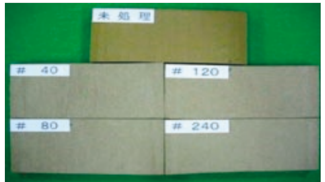
写真5 キセノンウエザーメーター処理後の試験体
