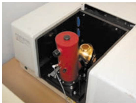
写真2 FTIRに積分球を取り付けた状態
