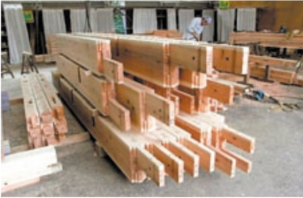
写真1 軸組材の加工
