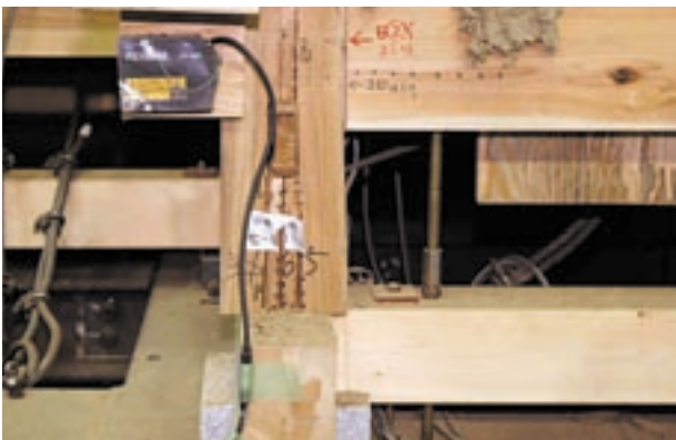
写真10 JMA神戸波100% 2回目後、柱脚柱割れ
