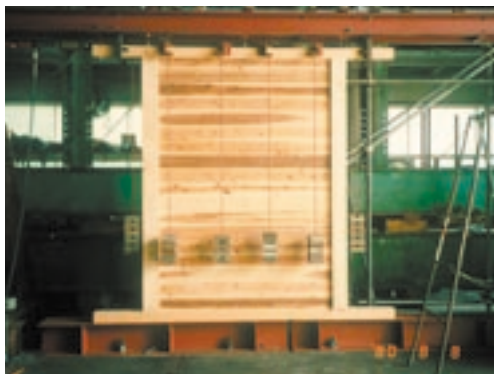
写真16 板壁の加力実験
