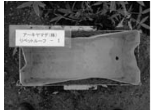
写真11 試験終了後の試験体状況 [ 草本：クマザサ ] 試験体番号：1
