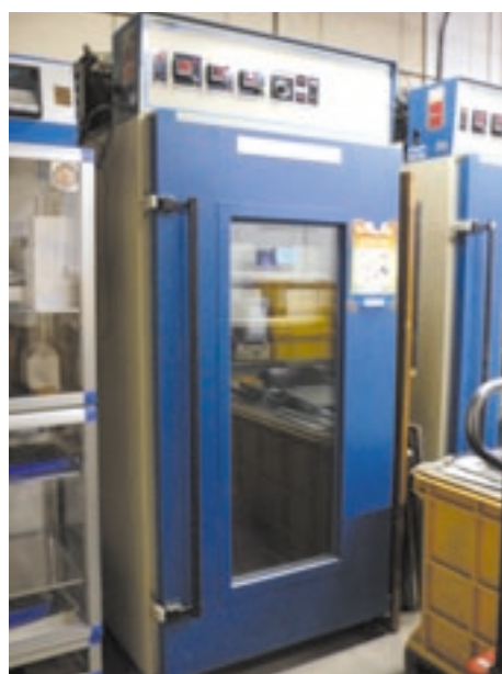
写真1 促進中性化試験装置
