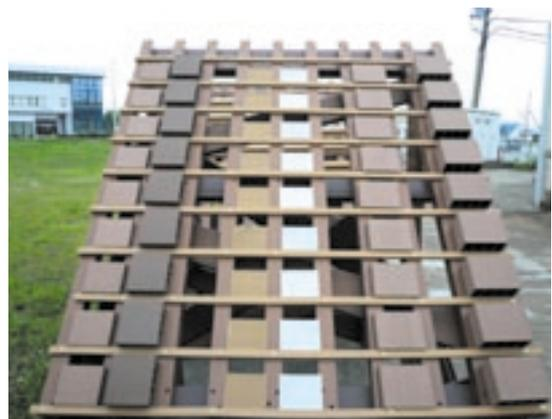
写真4 屋外暴露試験状況、暴露地；富山（南面に鉛直から45度に試験体が設置されている）
