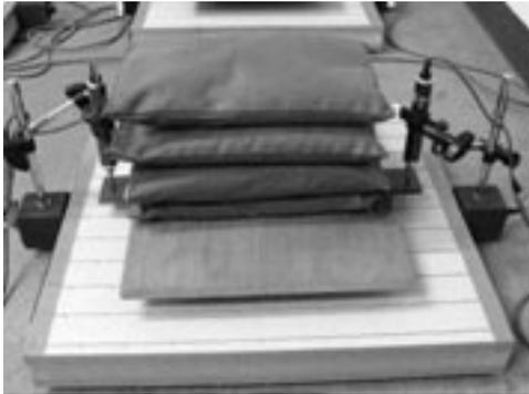
写真3 局部圧縮クリープ試験状況
