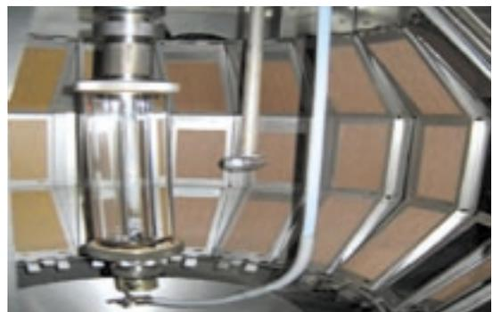
写真5 キセノンウエザーメータ処理状況(中心部にキセノン光源があり、その周囲に試験体が設置されている)
