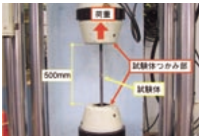
写真3 試験実施状況 試験体記号: D22
