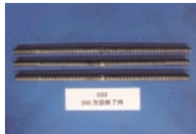
写真4 試験後の試験体の状況 試験体記号: D22
