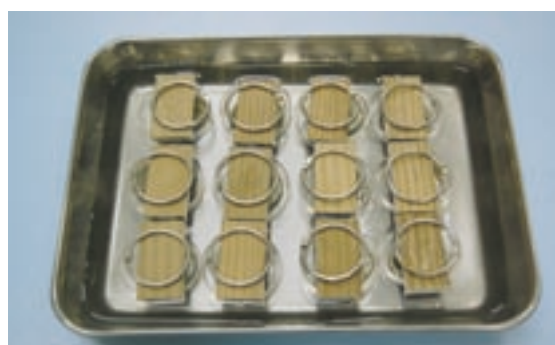
写真5 吸水係数試験状況
