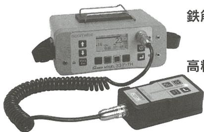
鉄筋の位置とかぶり厚さ、腐食度合をチェック出来る高精度の鉄筋探査機
