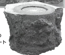
防水カップに付着した 打設コンクリート
