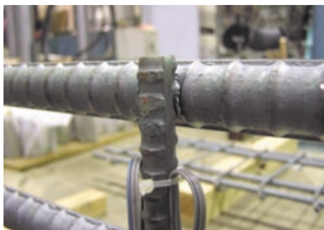
写真1 スポット溶接接合
