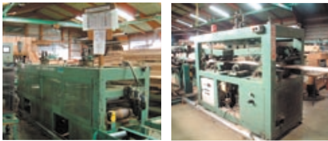
写真1 構造用集成材製造ラインで使用される機械 (左: 強度区分, 右: 保証荷重載荷)
