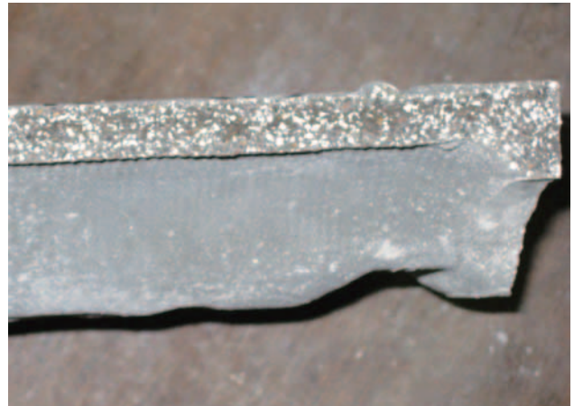
写真2 曲げ耐力試験後の瓦の断面
