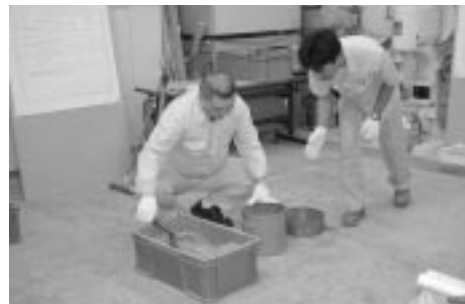
写真5 粒形判定実積率試験実習
