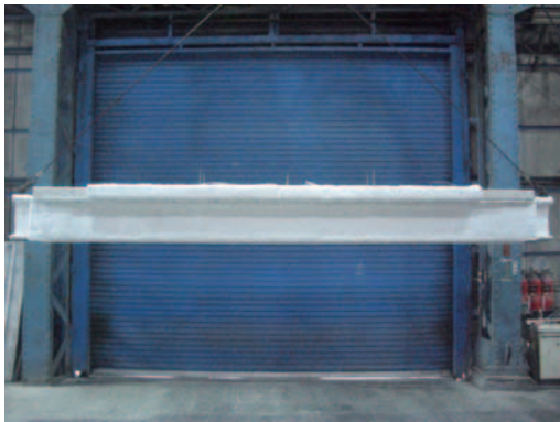
写真3 はり試験体外観
