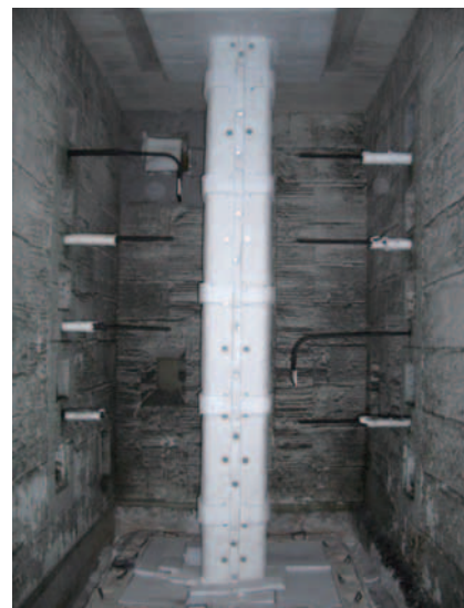
写真6 柱試験体外観 (標準断面)
