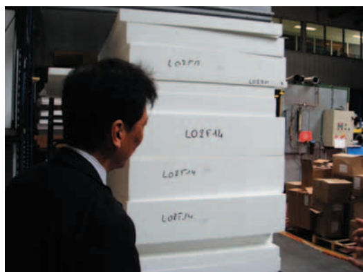
写真10 発泡プラスチック系断熱材（300mmを超える厚さの製品も保管されていた）
