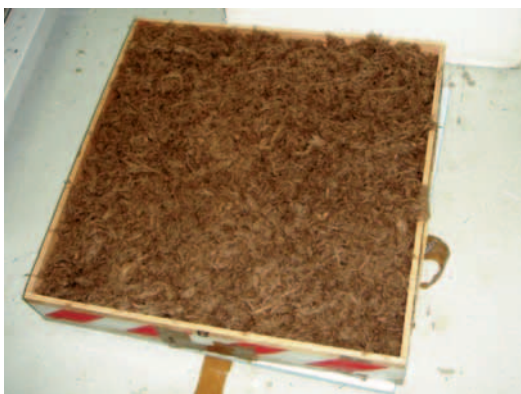
写真9 吹込み用繊維質断熱材（主に天井用の断熱材として使用される）
