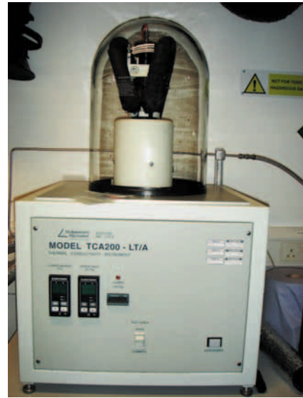
写真12 NPLの薄いプラスチック材料用のGHP法による熱伝導率測定装置
