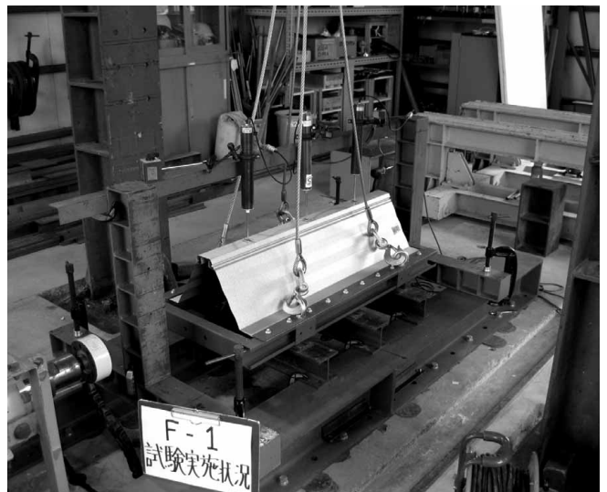
写真2 「鋼板製屋根構法標準 SSR2007」の性能試験
